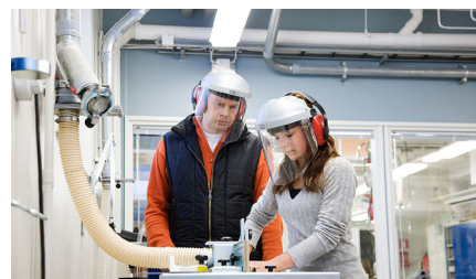
Oppilaitosten purun- ja tekstiilipölynpoistot
