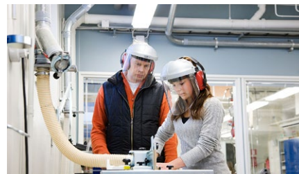
Oppilaitosten purun- ja tekstiilipölynpoistot
