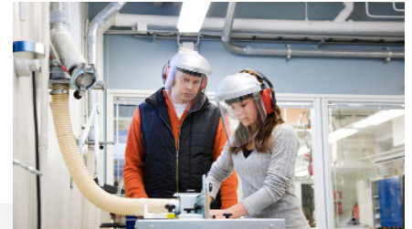
Oppilaitosten purun- ja tekstiilipölynpoistot
