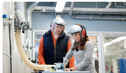
Oppilaitosten purun- ja tekstiilipölynpoistot
