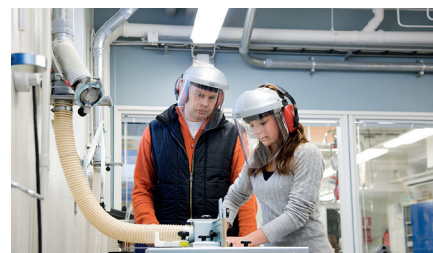
Oppilaitosten purun- ja tekstiilipölynpoistot
