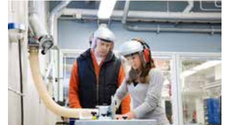
Oppilaitosten purun- ja tekstiilipölynpoistot
