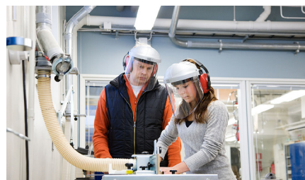
Oppilaitosten purun- ja tekstiilipölynpoistot
