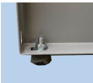
Jalat puhallin on tuettuna 3 jalalla, jolloin käynnissä ollessaan se ei ole renkaiden varassa
