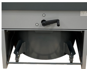
Pölyastia Metallinen pölyastia pikalukituksella.
