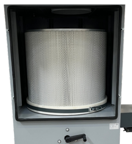
Helppo suodatinvaihto edessä olevan huoltoluukun kautta.
